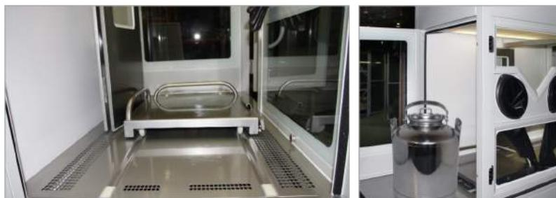
Передвижение предметов и материалов внутри рабочей камеры осуществляется с помощью тележки из нержавеющей стали, снабженной удобными ручками и механизмом фиксации.
