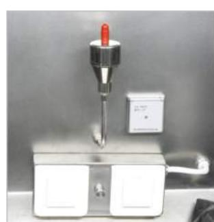
В рабочей зоне находится ПРОБООТБОРНИК ДЛЯ ПОДКЛЮЧЕНИЯ СЧЕТЧИКА ЧАСТИЦ, жестко закрепленный на задней стенке рабочей камеры.
