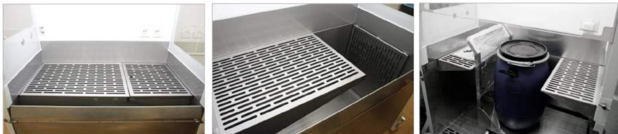
В рабочей камере установлены полки из нержавеющей стали AISI 304 толщиной 1,5 мм с воздухозаборными отверстиями по всей поверхности.
